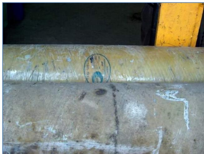
**Figure 39 : Concept de puits géothermique anticorrosion et Tubes (9<sup>5/8</sup>) en matériaux composites remontés au jour après 13 ans de service (puits de production GLCS1 de La Courneuve Sud) (source : GPC IP)**
